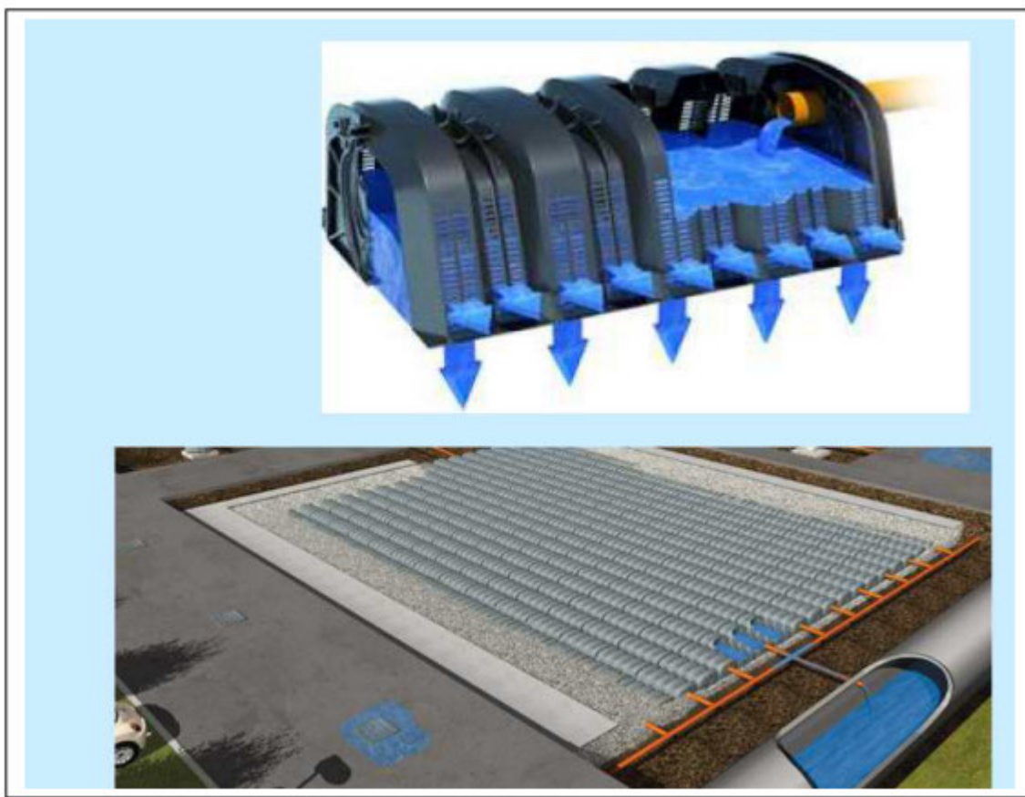
Sistemi di accumulo e drenaggio in PEHD
